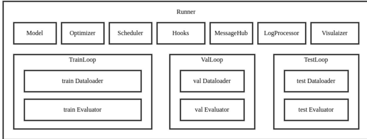
MMEngine 的执行器内包含训练、测试、验证所需的各个模块，以及循环控制器（Loop）和钩子（Hook）。用户通过提供配置文件或已构建完成的模块，执行器将自动完成运行环境的配置，模块的构建和组合，最终通过循环控制器执行任务循环。执行器对外提供三个接口：`train`, `val`, `test`，当调用这三个接口时，便会运行对应的循环控制器，并在循环的运行过程中调用钩子模块各个位点的钩子函数。
